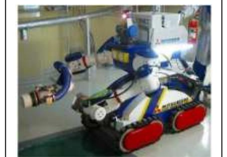
図 5.2.2 除染ロボットの例<sup>3)</sup>
