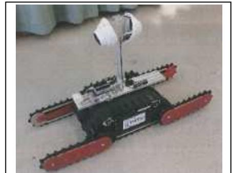
図 5.2.1 小型高踏破性遠隔移動装置<sup>5)</sup>
